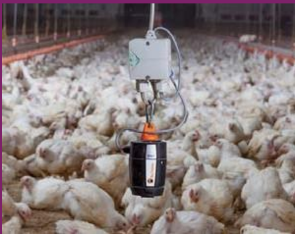
เครื่องวัดแอมโมเนียเป็นเครื่องมือที่มีประสิทธิภาพในการตรวจสอบคุณภาพอากาศ เครดิตรูปภาพ: BIG DUTCHMAN
