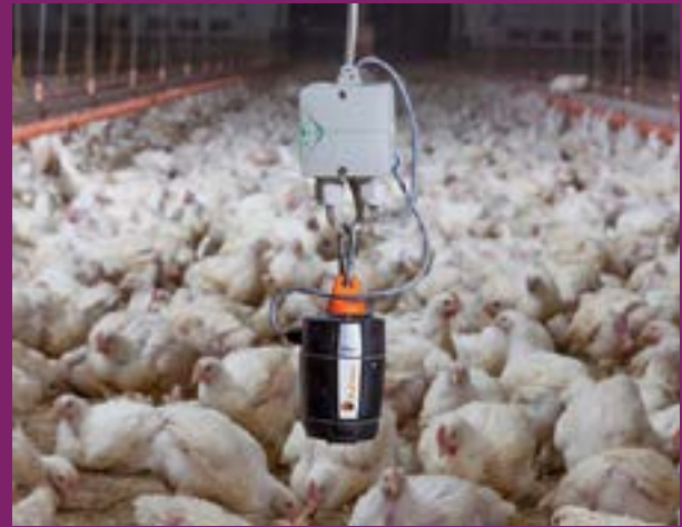
يمكن أن تكون مقاييس الأمونيا أداة فعالة لمراقبة جودة الهواء. PHOTO CREDIT: BIG DUTCHMAN
